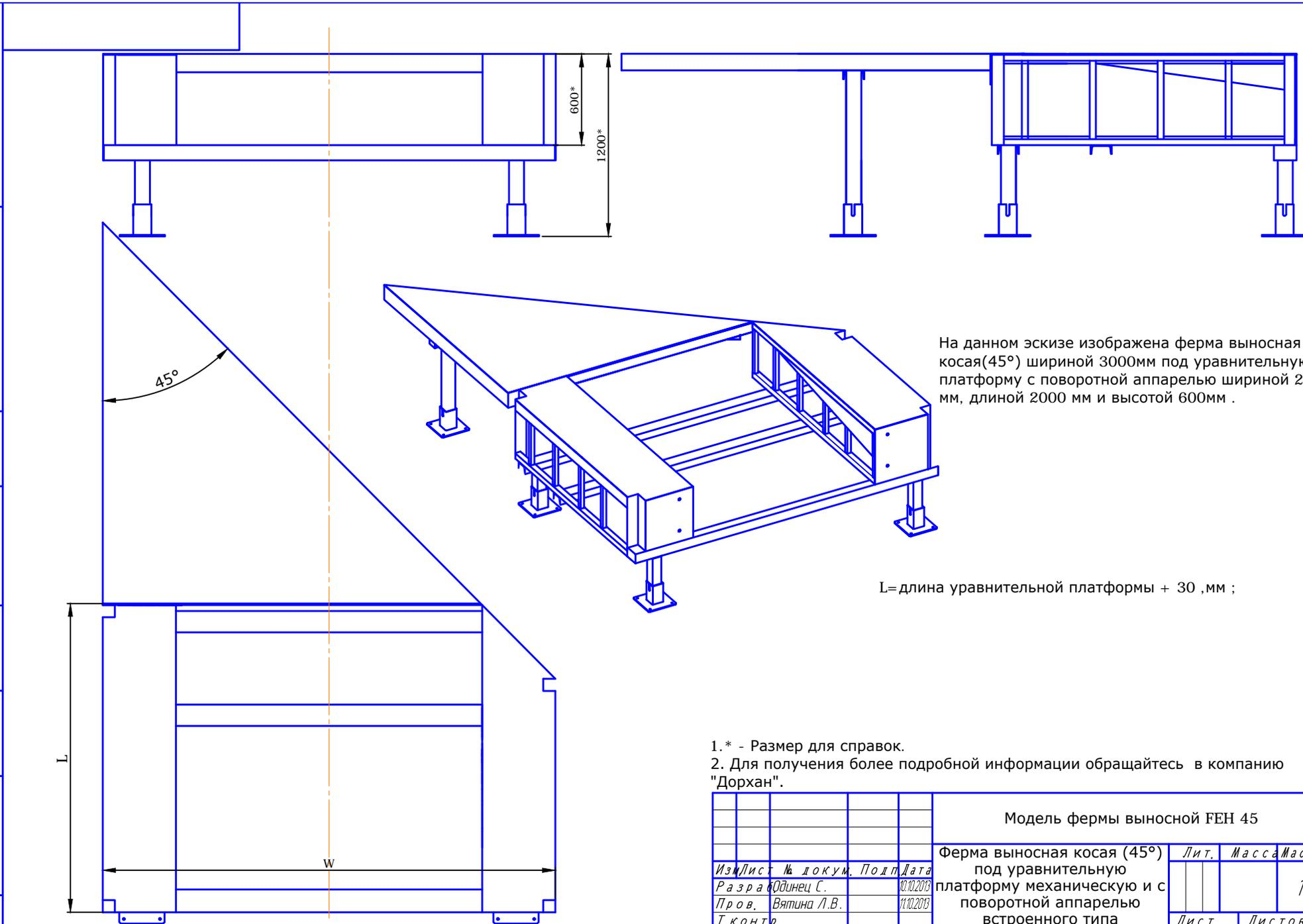
На данном эскизе изображена ферма выносная косяная (45°) шириной 3000мм под уравнительную платформу с поворотной аппаратурой шириной 2000 мм, длиной 2000 мм и высотой 600мм .
