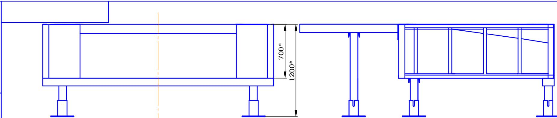
На данном эскизе изображена ферма выносная кося (60°) шириной 3000мм под уравнительную платформу с выдвижной аппарелью шириной 2000 мм, длиной 2000 мм и высотой 700мм.
