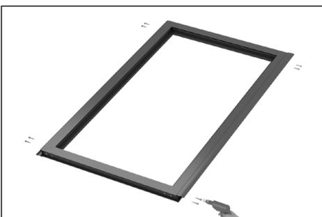
Закрепите профили «нащельник» при помощи саморезов крепления углового соединения.
