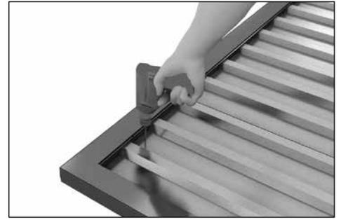
Для крепления профилированного стального листа просверлите отверстия сверлом  $\varnothing 4,2$  мм на расстоянии 40 мм.
